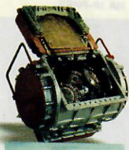
ГИРОПЛАТФОРМА — СЕРДЦЕ СИСТЕМЫ УПРАВЛЕНИЯ РАКЕТЫ, ВНУТРИ ВИДНЫ ГИРОСКОПЫ, ПОДОБНЫЕ ПОДНЯТЫМ СО ДНА РЕКИ ТИГР
